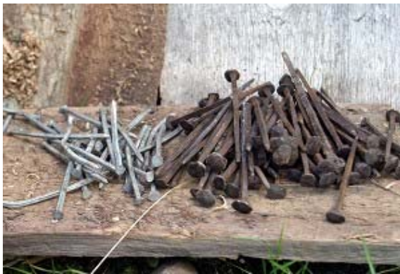
Ny spik och gammal spik. I Vintjärn arbetar man med att restaurera en gammal bostad.
